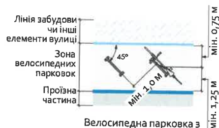
Велосипедна парковка з розташуванням стійок перепедиккулярно до стіни
