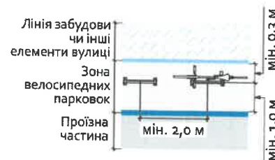
Велосипедна парковка з розташуванням стійок паралельно до стіни
